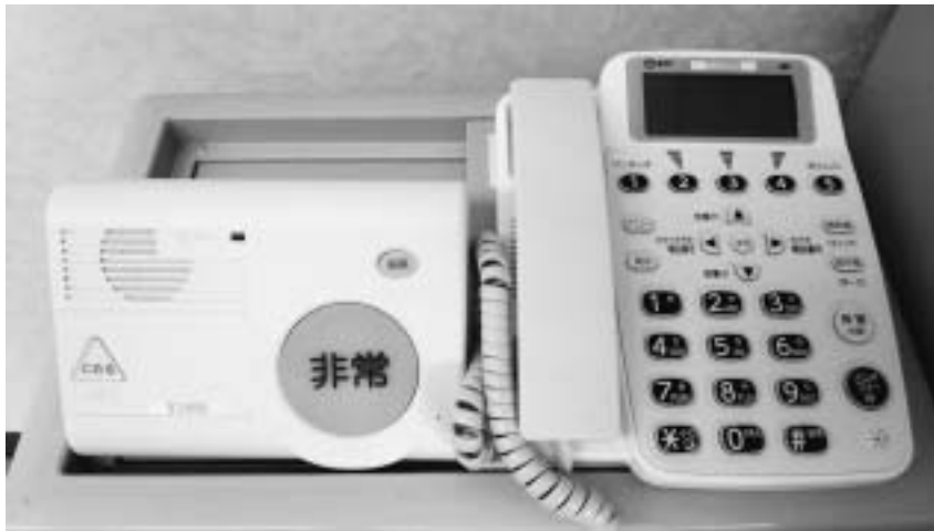
緊急通報用電話機
