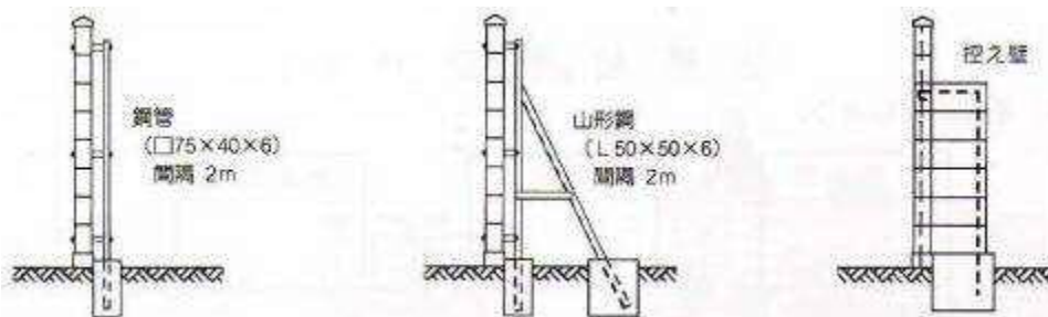
① 鋼柱(鋼管)式
