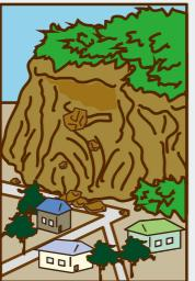
がけ崩れは地下にしみ込んだ雨により土の抵抗力が弱まり、斜面が急激に崩れ落ちる現象です。
